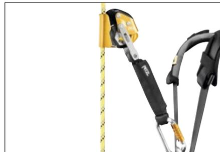
L'ASAP LOCK integra una funzione bloccante per ridurre l'altezza della caduta. Inoltre, è imperdibile nel superamento di frazionamenti. Si utilizza con un assorbitore di energia ASAP'SORBER.
