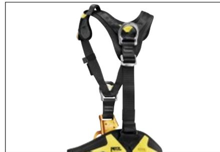
L'imbracatura completa ASTRO BOD FAST è dotata di un punto di attacco dorsale per collegare un sistema di arresto caduta. In caso di caduta su questo punto, una regolazione corta della lunghezza tra la cintura e i cosciali consente di ripartire il peso sui cosciali restando così sospesi più a lungo nell'imbracatura in attesa di soccorso.
