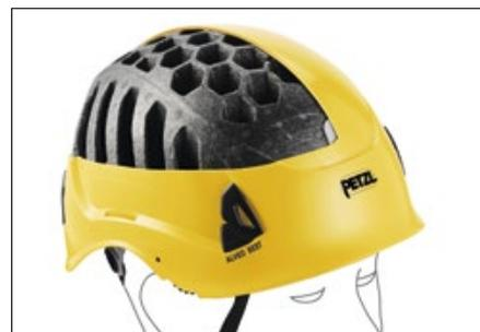
I caschi ALVEO sono dotati di un guscio interno in polistirene espanso, per garantire maggiore leggerezza. L'assorbimento degli urti avviene per deformazione del guscio interno in polistirene espanso.
