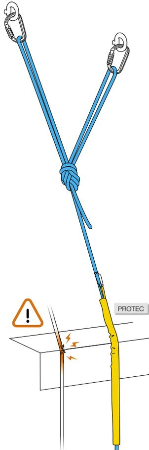
Caso particolare: isolare una parte di corda danneggiata con un nodo farfalla.
