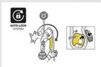
Il sistema AUTO-LOCK consente di posizionarsi facilmente sul posto di lavoro, senza dover utilizzare la maniglia e realizzare una chiave d'arresto: quando l'utilizzatore rilascia la maniglia, la corda è automaticamente bloccata nel dispositivo.
