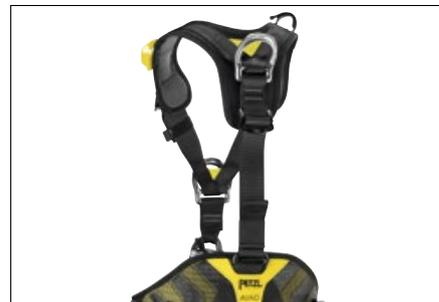
Le imbracature complete AVAO BOD e AVAO BOD FAST sono dotate di un punto di attacco dorsale per collegare un sistema di arresto caduta. In caso di caduta su questo punto, una regolazione corta della lunghezza tra la cintura e i cosciali consente di ripartire il peso sui cosciali restando così sospesi più a lungo nell'imbracatura in attesa di soccorso.
